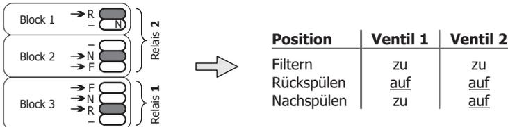
☛ Wenn Sie nur ein Ventil verwenden, wird es am Relais 1 angeschlossen. Sie können mit einem Ventil nur zwischen Filtern und Rückspülen umschalten. Bei der Voreinstellung für das Besgo-Ventil schaltet Relais 1 in der Position Rückspülen ein, da der Jumper im Block 3 auf Position "R" steckt. Das Ventil 2 (zuständig für Nachspülen) schaltet auf Position Rückspülen und Nachspülen ein. Daher steckt im Block 1 der Jumper auf "R", und im Block 2 auf Position "N".
