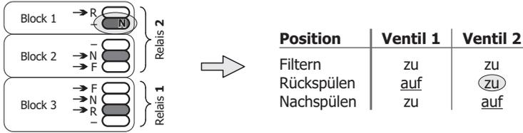
☒ Das Ventil 2 von Astral muss also beim Rückspülen ausgeschaltet sein. Daher wird der Jumper im Block 1 auf die funktionslose Position "–" umgesteckt.
