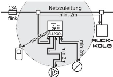
☑ Durch das Einhalten der minimalen Kabellängen vermeiden Sie das Risiko von Störungen, die induktive Lasten wie Schutz- oder Magnetventilspulen oder Pumpen verursachen können. Sie haben auch den Vorteil, das spätere Änderungen an der Anlage leichter durchführbar sind.
